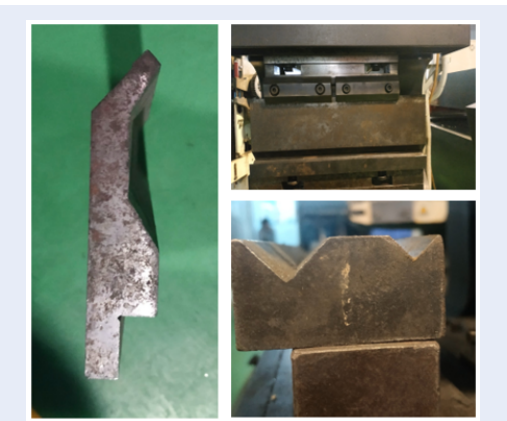
Hình 3: Bộ khuôn chấn thực nghiệm góc 90
