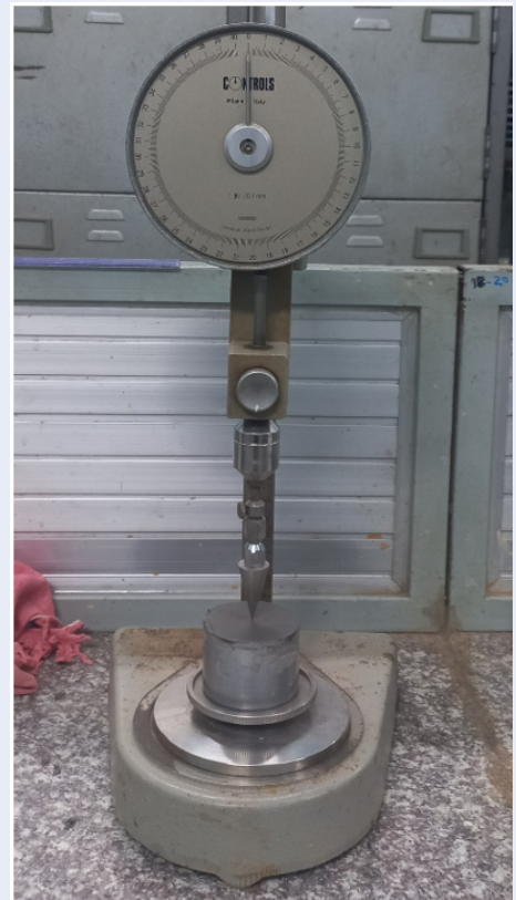
Hình 5: Chùy xuyên có khối lượng 240 g và thí nghiệm thả chùy xuyên
