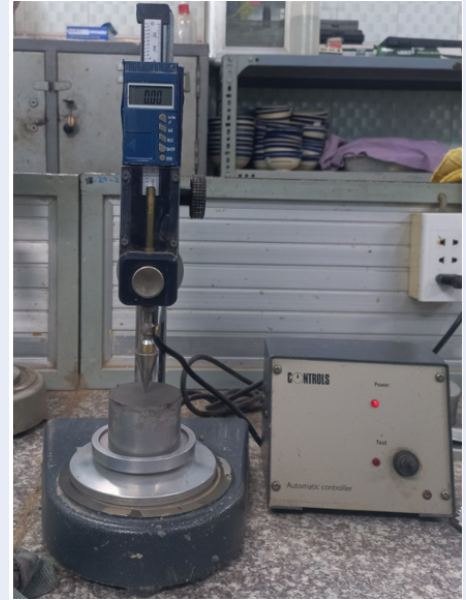
Hình 4: Chùy xuyên có khối lượng 80 g và thí nghiệm thả chùy xuyên
