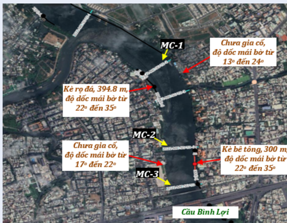
Hình 8: Vị trí các mặt cắt ngang khảo sát trên sông Sài Gòn, bao gồm mặt cắt MC-1, MC-2 và MC-3 cùng với các phương án kè trong thực tế ứng với các độ dốc mái bờ từ năm 2022, khu vực cầu Bình Lợi, Phường 13, Quận Bình Thạnh, TP.HCM 13,16 .
