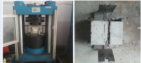
Hình 7: Thí nghiệm xác định cường độ chịu kéo khi ép chế của bê tông (nguồn: Nhóm tác giả)
