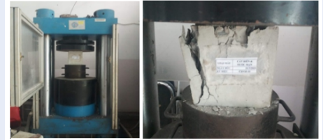
Hình 6: Thí nghiệm xác định cường độ chịu nén của bê tông (nguồn: Nhóm tác giả)
